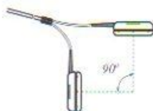
Рис. 4. Установка виброфонов под углом 90^\circ относительно друг друга.
